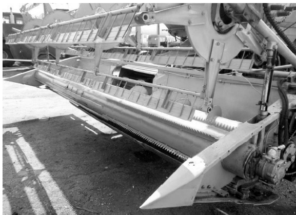
Рис. 6. Адаптер (барабан с зубчатым очесывающим устройством к жатке для уборки зерновых методом «очеса»)
