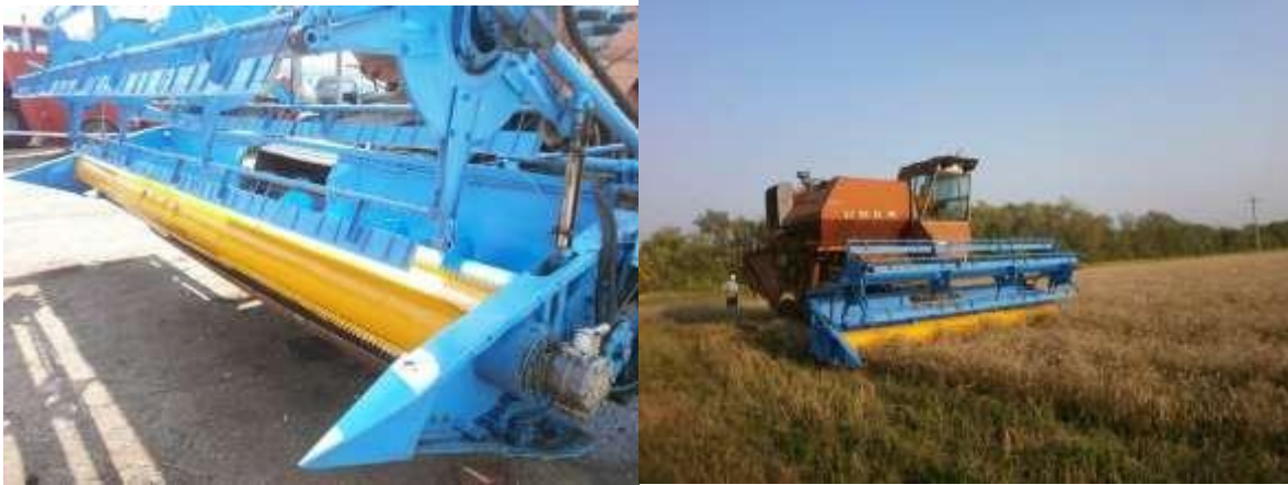
Рис.2. Жатки для уборки зерновых методом «очеса»:
