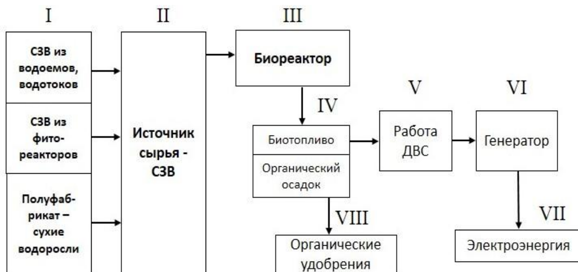
Рисунок 1 – Виды (состояние) сине-зеленых водорослей для переработки (I), источник сырья СЗВ для получения биотоплива (II), биореактор (III), двигатель внутреннего сгорания (V), генератор (VI), производимая продукция: биотопливо (IV), электроэнергия (VII), органические удобрения (VIII).
